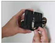
取出底座, 將連接器插入底座底部的插槽內。
