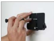
調整壁掛底座的位置並鎖緊螺絲。
